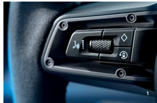
1 Rekuperationstaste am Lenkrad zum Wechseln der Rekuperationsstufen
