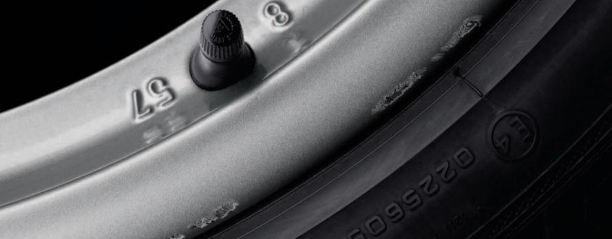
Незначительное повреждение лакокрасочного покрытия обода колёсного диска
