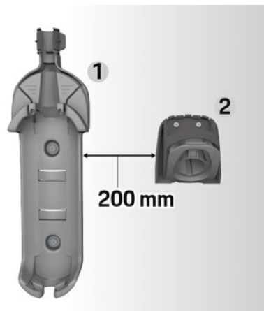
Слика 2: Растојание од сидниот држач до држачот за конектор
