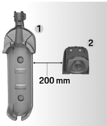
Fig. 2: Distanță de la suportul de perete la dispozitivul de fixare a conectorului
