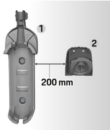
2 pav. Atstumas nuo sieninio laikiklio iki jungties tvirtinimo elemento
