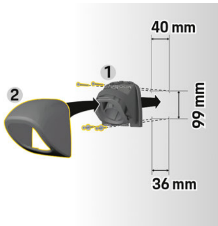
Фиг. 3: Размери за пробиване
