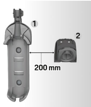
Sl. 2: Rastojanje od nosača za zid do pričvršćivača za konektor
