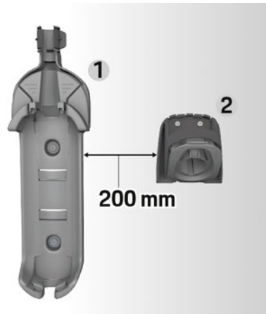
Kuva 2: Seinäpidikkeen ja pistokkeen pitimen välinen etäisyys
