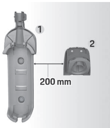
Obr. 9: Vzdialenosť spony na konektor od držiaka na stenu
