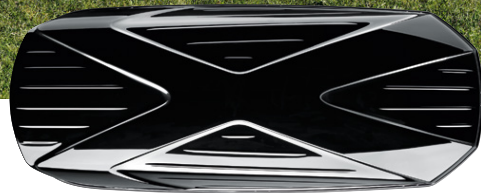
Caixa de tejadilho 520 (520 litros) 218 × 89,5 × 40 cm, em preto (brilhante), carga útil máxima permitida: 75 kg, caixa com fecho em plástico com esquis integrados, abertura pelos dois lados
