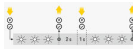
Εικ. 215 Ακολουθία κουμπιών για την απενεργοποίηση της επιτήρησης γείωσης
