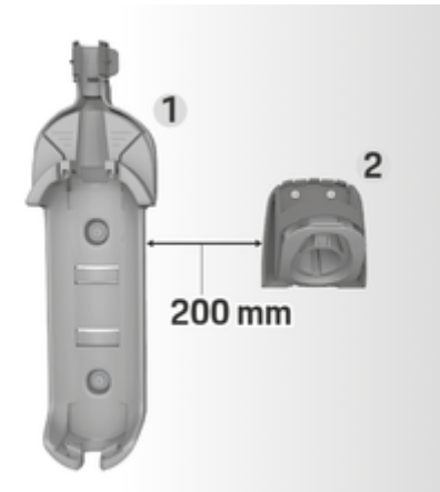
Εικ. 207 Απόσταση μεταξύ επιτοίχιας βάσης και βάσης στήριξης
