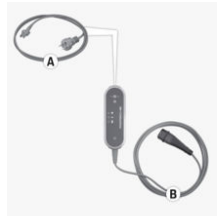
Sl. 300 Priklučci na kontrolnoj jedinici
