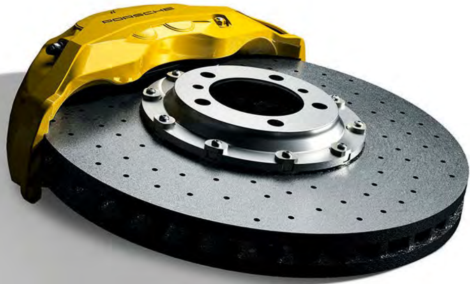
1 포르쉐 세라믹 컴포지트 브레이크(PCCB): 브레이크 디스크 직경 440mm(전륜) 및 410mm(후륜)
