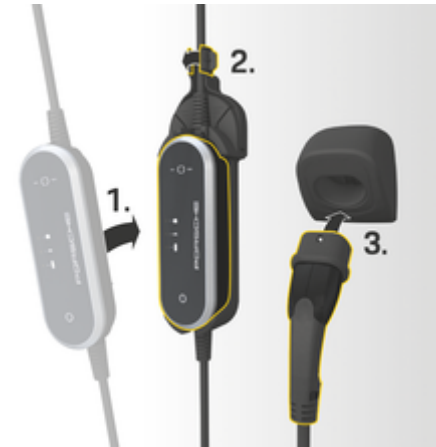
図 6: コントロールユニットの取り付け
