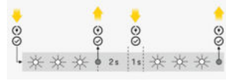
그림 271 접지 모니터링 비활성화를 위한 키 순서
