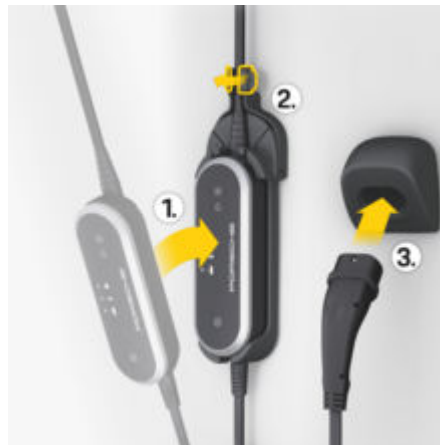
図. 246 コントロールユニットの取り付け
