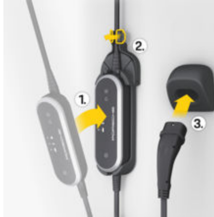
الشكل 227 تركيب وحدة التحكم
