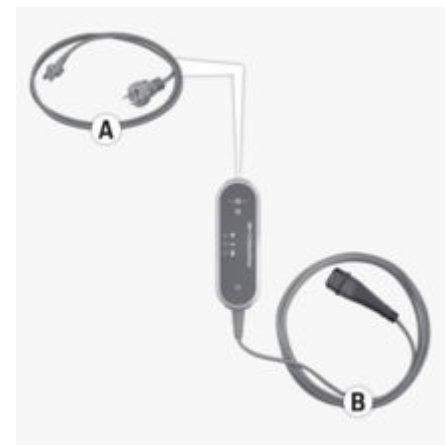
Att. 114 Savienojumi vadības blokā
