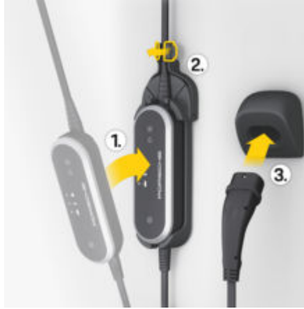
Çizim 137 Kontrol ünitesinin takılması
