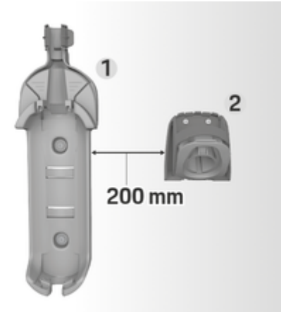
그림 249 벽걸이 장착 장치와 커넥터 잠금 장치 간 거리 커넥터 잠금 장치를 설치할 때 기본 벽걸이 장착 장치와 200mm의 거리를 보장하십시오.
