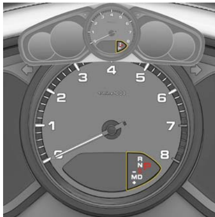
図 110：インストルメント・クラスターのモードと係合ギアのインジケータ
