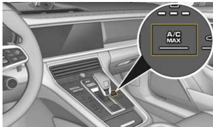
図 41: A/C MAX モードの起動と解除
