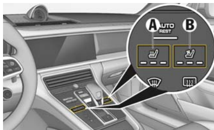
図 58：フロント・シート・ヒーター/フロント・シート・ベンチレーターのON/OFF
