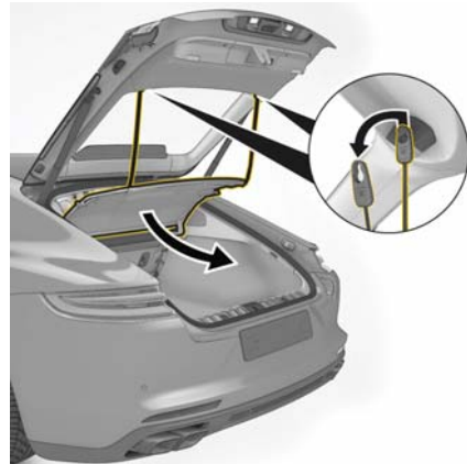
図 171: ラゲッジ・コンパートメント・カバーを取り外す
