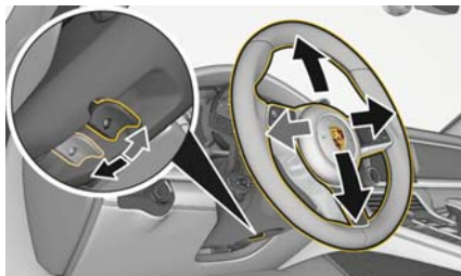
図 66：ステアリング・ホイールの調節レベルの固定
