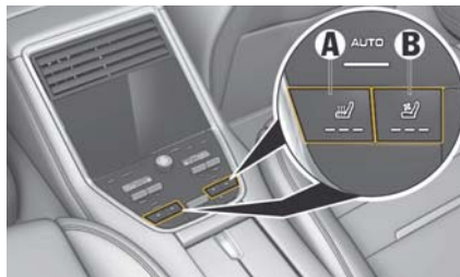
図 59：リヤ・シート・ヒーター/リヤ・シート・ベンチレーターのON/OFF
