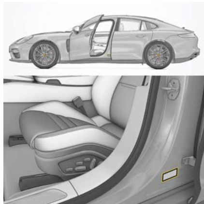
図 208 : タイヤ空気圧プレート固定位置
