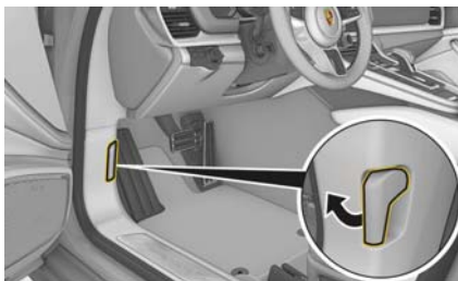
図 150：ボンネットのロックを解除する
