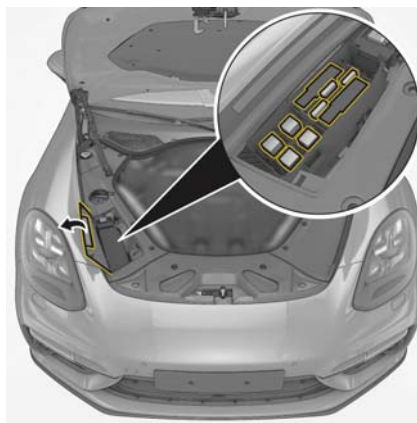
図 129: エンジン・コンパートメントのヒューズ・ボックス
