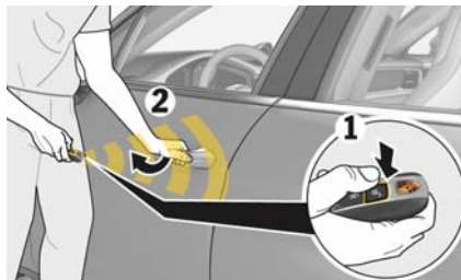
図 77：キーによるドア・ロックの解除
