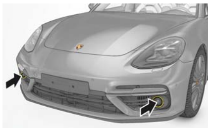
図 1：レーダー・センサーの取り付け位置
