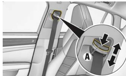
図 61：シートベルトの高さを調節する
