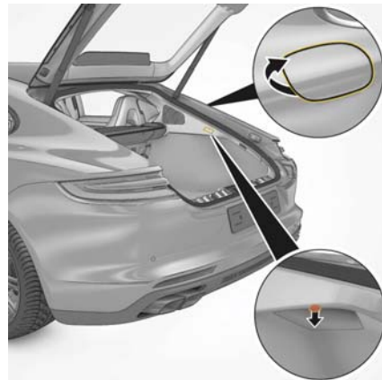
図 38：緊急時のフィルター・フラップのロック解除
