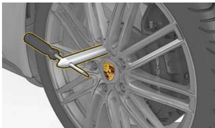
図 96 : 組み付け補助工具 1 本を使用 (PCCB 非装備車)
