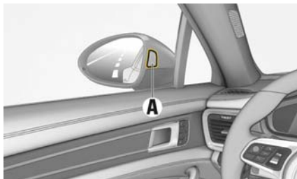
図 193 : ドア・ミラーの警告インジケーター A
