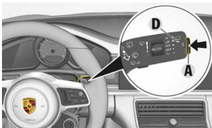
図 136: リア・ウィンドウ・ワイパー用のボタン (A) およびインジケーター・ライト (D)
