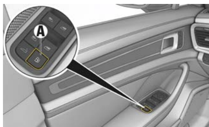
図 35：フィルター・フラップのリリース（ハイブリッド・ドライブ）
