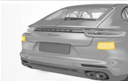
図 194：リヤ・バンパー内のレーダー・センサー
