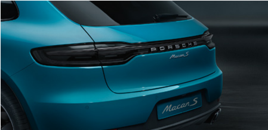
Luci posteriori a LED inclusa fascia di raccordo luminosa scura
