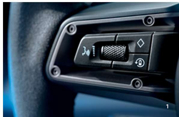
1 Tasto di recupero dell'energia sul volante per la selezione dei livelli di recupero
