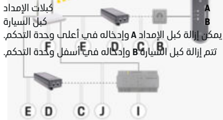
الشكل 166 توصيل الشاحن وجهاز إدارة الطاقة عبر جهاز توجيه (مثال التطبيق)
