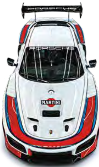
Wie bereits beim historischen Vorbild wurden große Teile der Karosserie durch Anbauteile aus Kohlefaser-Verbundwerkstoff (CFK) ersetzt beziehungsweise ergänzt
