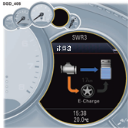
通过内燃机驱动并为高压蓄电池充电 内燃机驱动车轮并通过电机为高压蓄电池充电，此时电机相当于发电机。同时为高压蓄电池充电会将内燃机的负荷点向上移动。因此，内燃机在最佳效率范围内工作。有关在驾驶时为高压蓄电池充电的信息： ▷ 请参见第 21 页的“行驶充电 - E-CHARGE 模式”章节。
