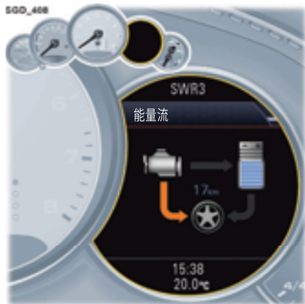
通过内燃机驱动 内燃机驱动车轮。
