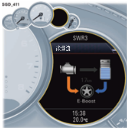
通过内燃机和电机驱动 内燃机和电机同时驱动车轮（例如，在助推过程中）。高压蓄电池在此过程中放电。
