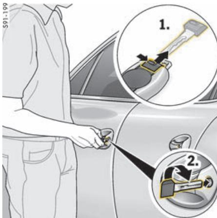
7. 将紧急车匙插入车门锁，锁止驾驶员侧车门。
