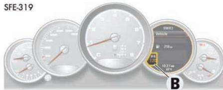
当自适应巡航定速控制系统启用时，状态显示 B 变为橙色。
