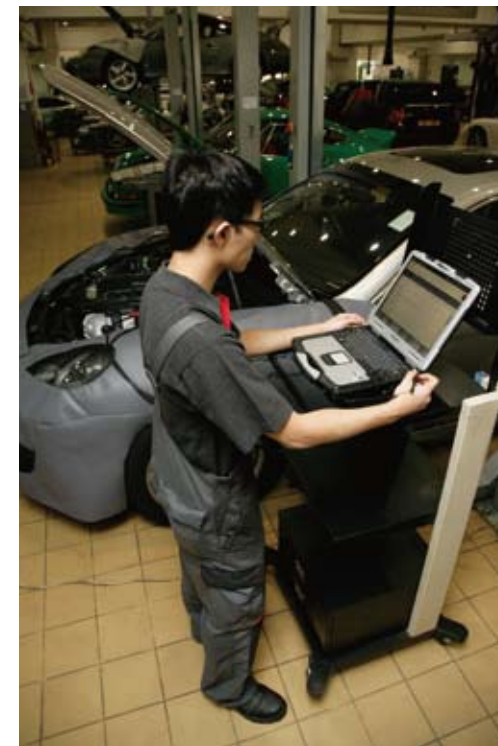
保时捷技师在 Panamera Turbo 交车前检查中使用新版 PIWIS 测试仪。
