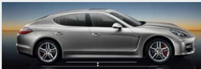
▲ 标准高度 - 根据德国工业标准, 系统处于标准高度时的车身最大离地间隙为 144 mm。
