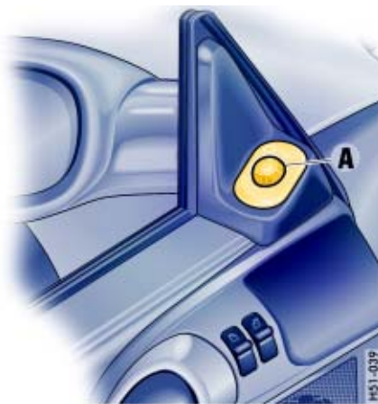
A - 用于车门镜调节的控制开关
