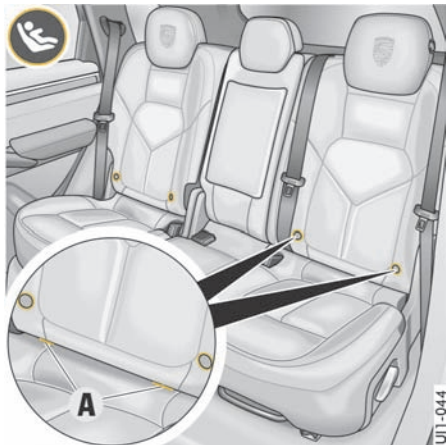
后排外侧座椅上的 ISOFIX 固定系统
