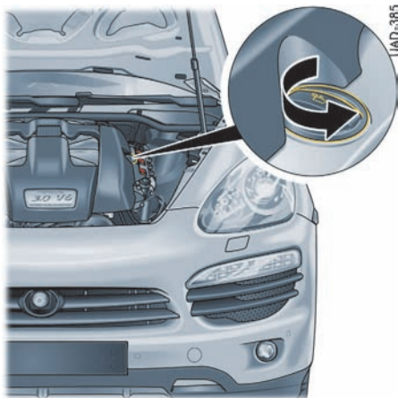
V6 发动机上的机油加注点
