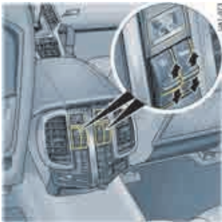
温度和风量，后部控制面板（4 区域恒温空调）
