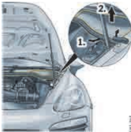
打开发动机舱内的保险丝盒盖 1. 拆下盖罩。
