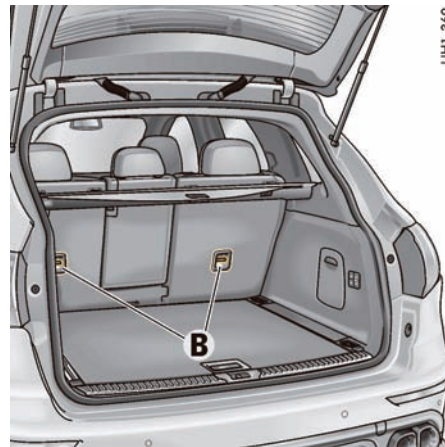
带有 ISOFIX 顶部系链的儿童保护系统的固定点
