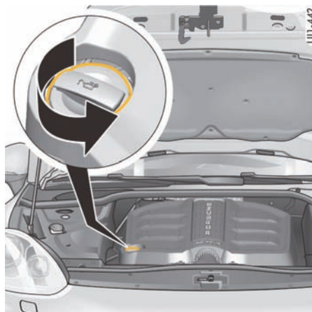
Cayenne S、Cayenne GTS 上的机油加注点
