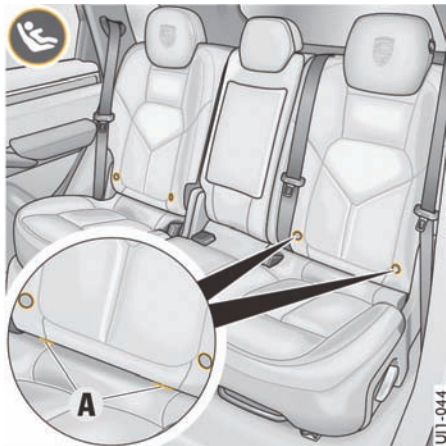
后排外侧座椅上的 ISOFIX 固定系统
