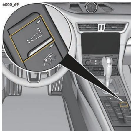
图 184: 中控台后扰流板的按钮
