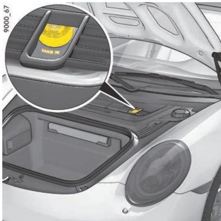
图 224：制动液储液罐
