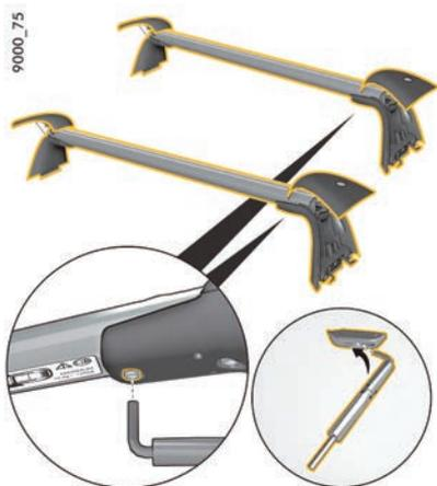
图 52: 拧紧托架底面的螺钉
