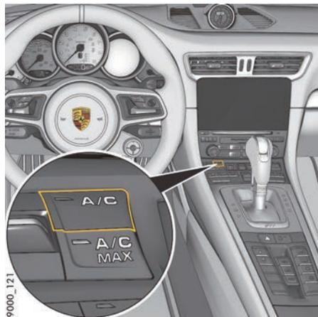
图 240：开启和关闭制冷功能
