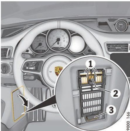
图 9: 左侧脚坑的保险丝盒中的元件
