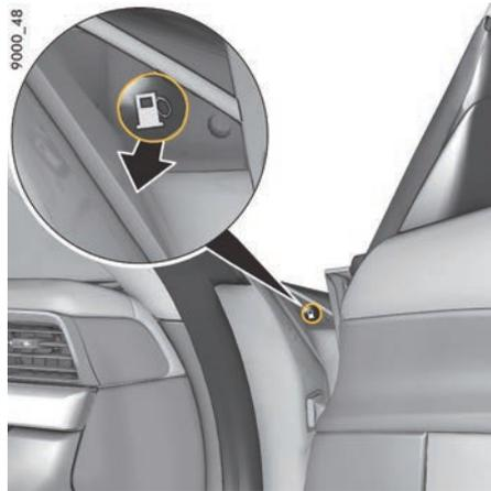
图 141: 加油口盖紧急操作
