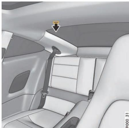
图 143: 撬开车顶衬里上的护盖
