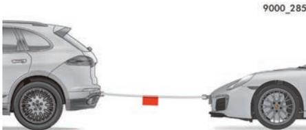
牵引时会增加事故风险。可能无法提供动力辅助，以便转向要求更大的力。如果制动助力器出现故障，您将需要大力来进行制动。
