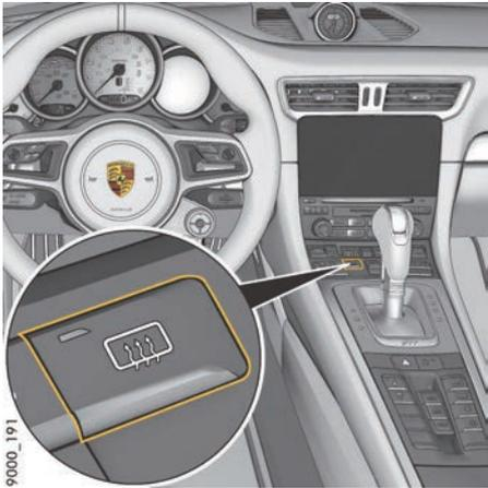
图 138: 加热式后窗 / 车外后视镜加热按钮
