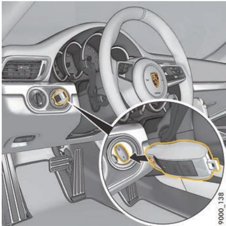
图 177：将车钥匙插入点火锁
