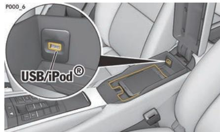
图 31: 中控台中的 USB 端口
