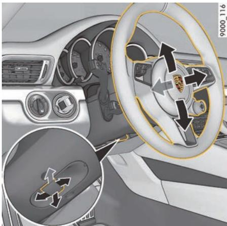
图 107：方向盘调节控制开关
