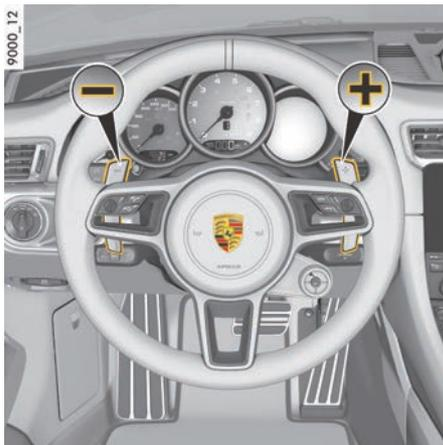
图 18：带换挡拨片的方向盘
