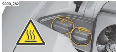
发动机运转时，发动机舱中的发动机和邻近部件会变得非常热。冷却液箱内有一定的压力。即使发动机已关闭且驾驶员车匙已拔出，风扇也可以自动开始运转。
