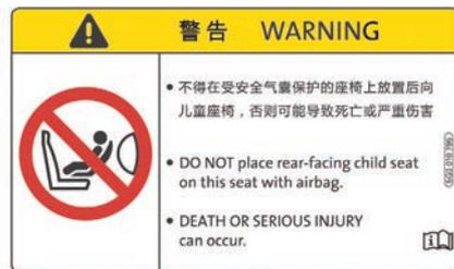
图 97：遮阳板上的安全气囊警告标签
