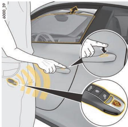
图 229: 使用保时捷免钥匙进入系统锁止车门
