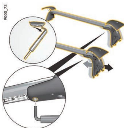
图 50: 松开托架底面的螺钉。
