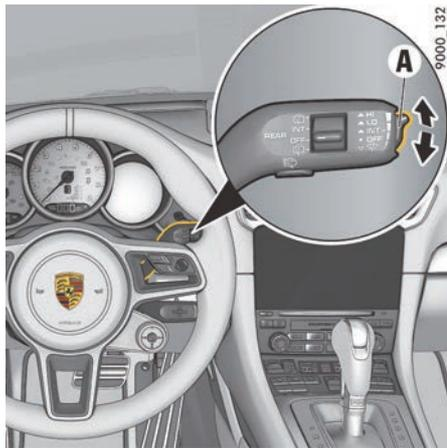
图 68: 雨量传感器灵敏度开关
