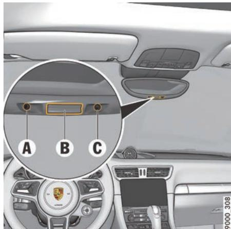
图 114: 内后视镜的自动变光功能
