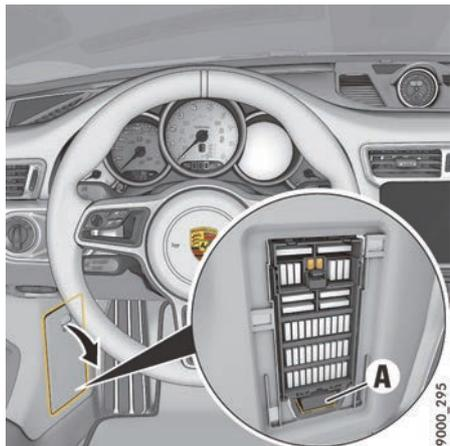
图 222：左侧脚坑的保险丝盒中的诊断插座
