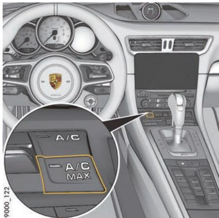
图 241：启用最大制冷输出功率
