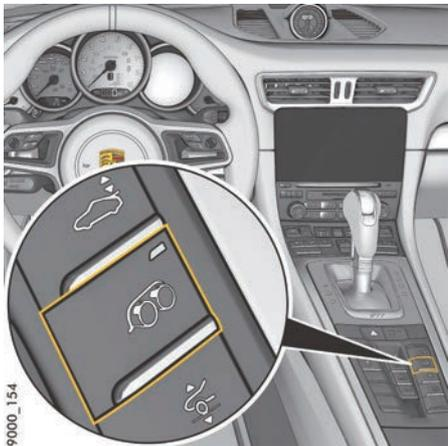
图 219: 中控台中运动型排气系统的按钮
