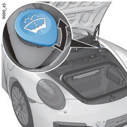
图 196: 挡风玻璃和大灯的洗涤液储液罐
