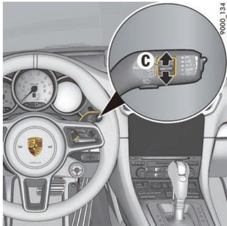
图 70: 后窗雨刷器的开关
