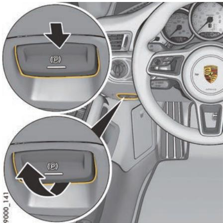
图 223：电子驻车制动器按钮
