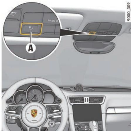
图 195：顶置控制台上的按钮
