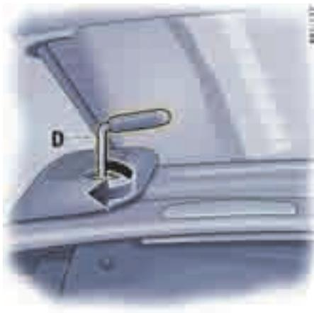
13. 用手拧紧紧固螺钉。然后，再用解锁手柄 D 拧紧（紧固扭矩 46 Nm）。
