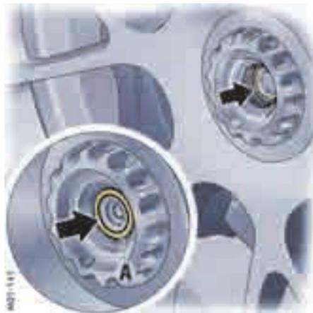
12. 拆下套筒扳手，并检查锁销 **A** 是否已经自动卡入中心螺栓中。锁止螺栓应与中心螺栓的内齿齐平。如果锁销仍然在后部位置，必须使用工具包里的方形杆等类似工具将锁销转到左侧和右侧，直到其卡入中心螺栓中。
