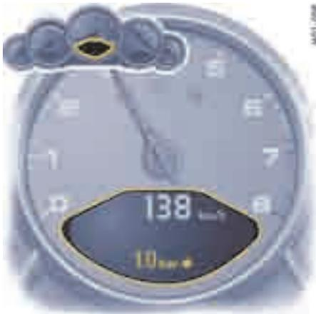
增压压力显示旁边出现一个箭头。超级增压的有效工作时间大约为 10 秒。在此之后, 可以通过快速将油门踏板踩到底重新激活该功能。
