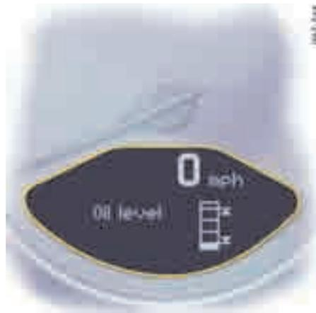
7. 如果底部数据段充满，则机油油位已经到达最低标记。立即添加机油
