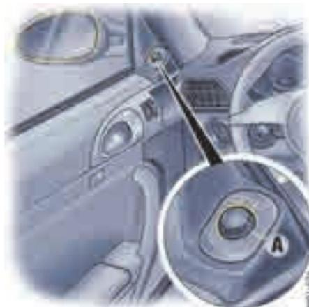
A - 车后视镜调节的控制开关
