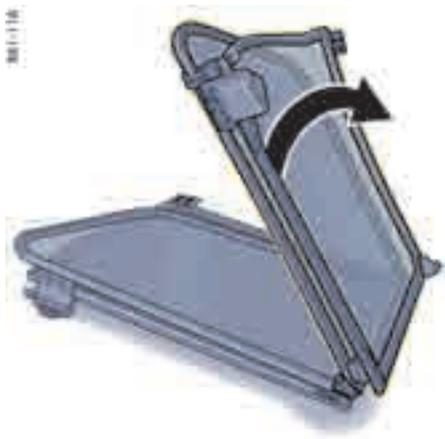
3. 展开挡风板，直到您可以感觉到其顶部和底部的铰链卡止。
