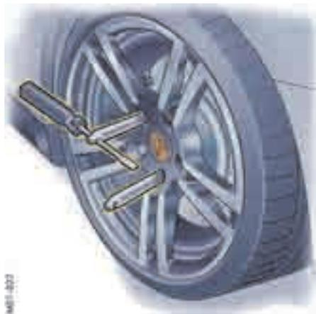
对于**配备**保时捷陶瓷复合制动系统（PCCB）的车辆，拧入**两个**装配辅助工具
