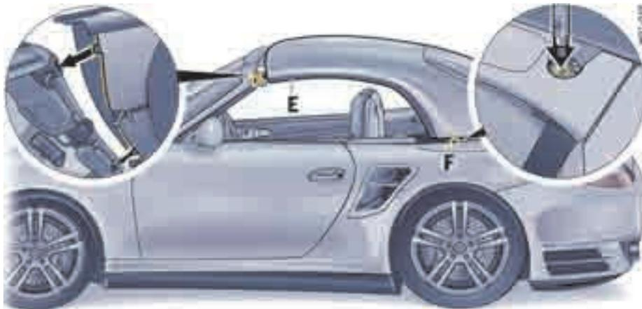
7. 检查硬顶上的后部螺纹接头是否松开（顺时针转动 2 圈）。
