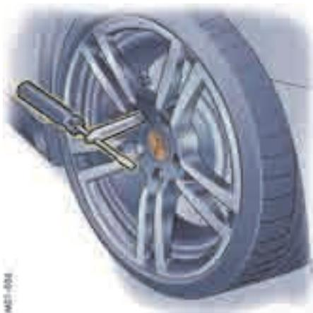
对于**未配备**保时捷陶瓷复合制动系统（PCCB）的车辆，拧入装配辅助工具。
