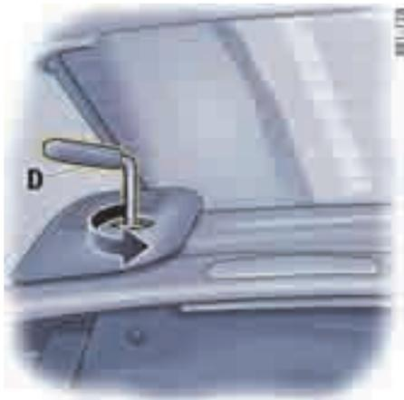
6. 将解锁手柄 **D** 插入一个后部硬顶锁中。松开紧固螺钉约 2 圈，取下手柄并用手完全松开螺钉（约 8 圈）。
