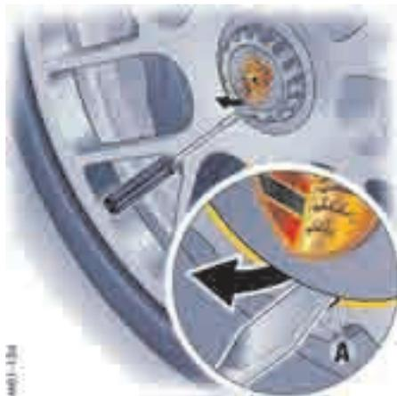
4. 使用一个小螺丝刀小心地将车轮螺栓盖从基座上撬出。
