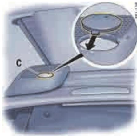
15. 将两个塑料盖 C 装入后部硬顶锁的饰板，使标记圆点对齐。
