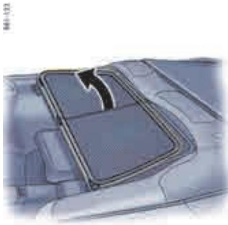
6. 将挡风板的紧固锁舌 C 插入安全带导向装置。确保塑料销钉 E 卡止在挡风板的中间导向装置上。
