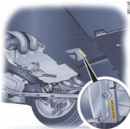
发动机号 在拆下车底护板后，可以看到压印在曲轴箱下侧的发动机号。
