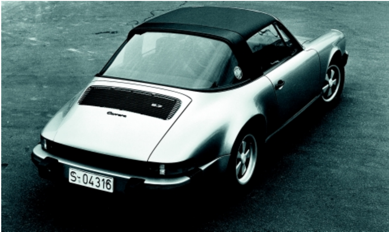
Um Carrera com carroceria Targa e pára-choques retráteis, exigidos pela legislação norte-americana.
