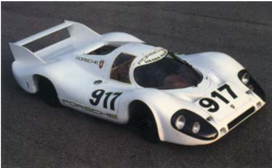
1970: o 917LH, desenvolvido em túnel de vento para altas velocidades.
