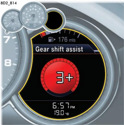
所有刻度標線顯示紅色時，「+」記號會在顯示器中顯示於排入檔位旁邊，是換至下一個較高檔位的換檔指示器。
