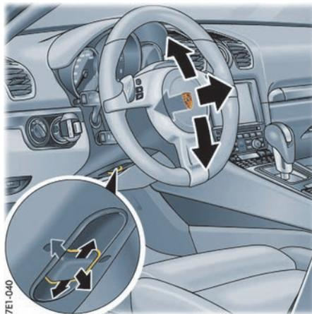
電動方向盤調整
